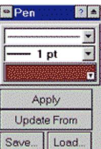
Cette palette flottante très utile pour dessiner les traits est obtenue par le menu <u>T</u> ools <u>P</u> en <u>S</u> tyle Panel. Elle permet de régler la couleur, l'épaisseur des traits il faut cliquer sur <u>A</u> pply pour appliquer les réglages à l'objet sélectionné. |
